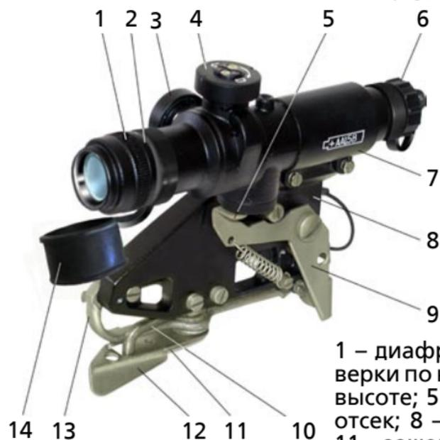
1 – диафрагма; 2 – объектив; 3 – механизм выверки по направлению; 4 – механизм выверки по высоте; 5 – кнопка; 6 – крышка; 7 – батарейный отсек; 8 – кронштейн; 9 – рычаг; 10 – поводок; 11 – защелка; 12 – рукоятка; 13 – направляющая; 14 – крышка
