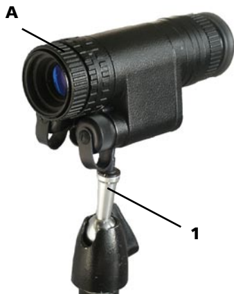
Рисунок 2 – Общий вид прибора МПН-8КМ с объективом 1 х на штативе
